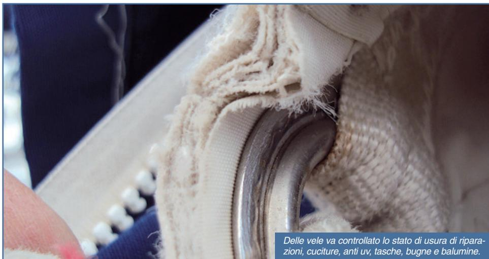
Delle vele va controllato lo stato di usura di riparazioni, cuciture, anti uv, tasche, bugne e balumine.
